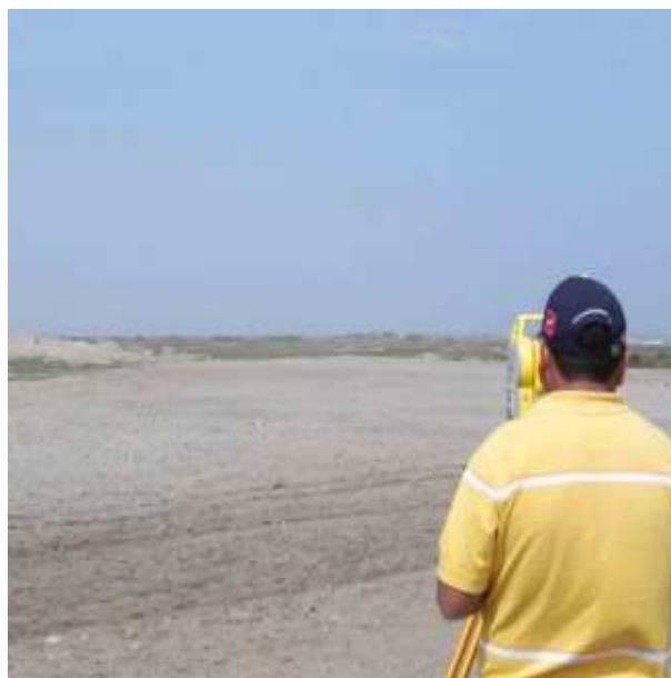
Figura 4. Trabajos de mapeo utilizando una Estación Total Electrónica TOPCON, modelo GTS-211D
