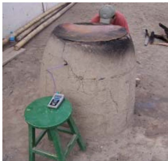
Figura 16. Posicionamiento del termopar utilizado para medir las temperaturas dentro del horno durante la cocción.
