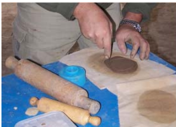
Figura 12. Realización de plaquitas de arcilla de tamaño estándar con un sacabocados.
