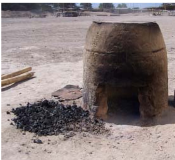
Figura 13. Horno construido en ladrillos de adobes por Julio Ibarrolla para la fabricación de réplicas de cerámicas mochicas procedentes de SJM.
